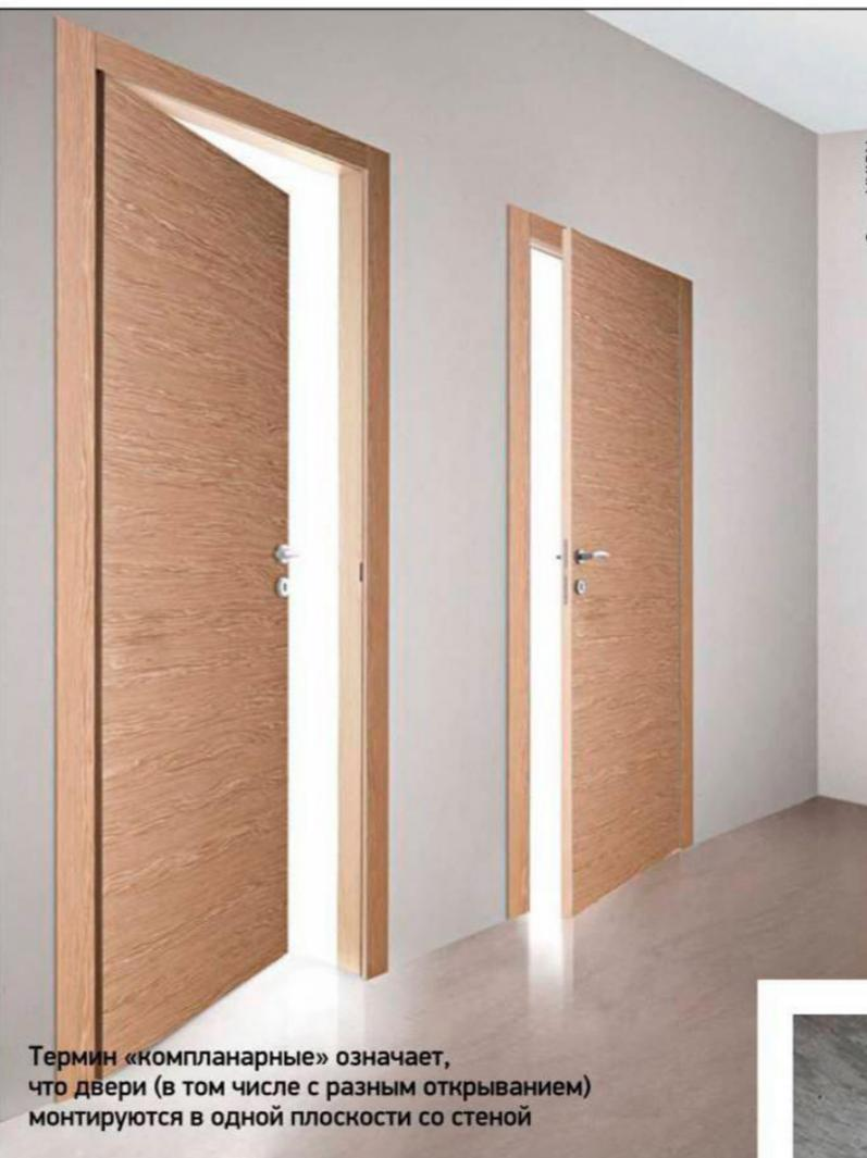
Термин «компланарные» означает, что двери (в том числе с разным открыванием) монтируются в одной плоскости со стеной
