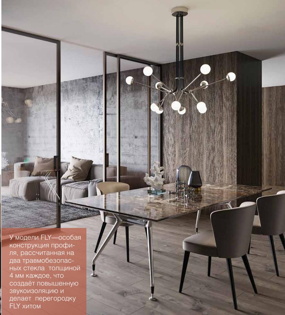
У модели FLY—особая конструкция профиля, рассчитанная на два травмобезопасных стекла толщиной 4 мм каждое, что создаёт повышенную звукоизоляцию и делает перегородку FLY хитом
