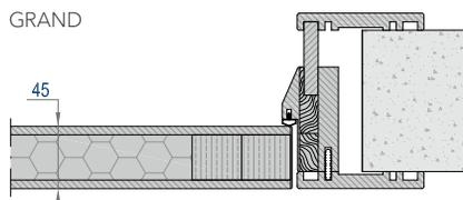
Традиционное исполнение, толщина полотна 45 мм, короб UNIDOOR, полотно и наличники в одной плоскости
