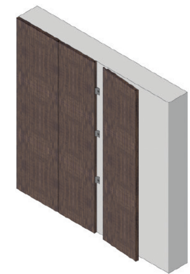
Installazione pannelli successivi Boiserie-V.
