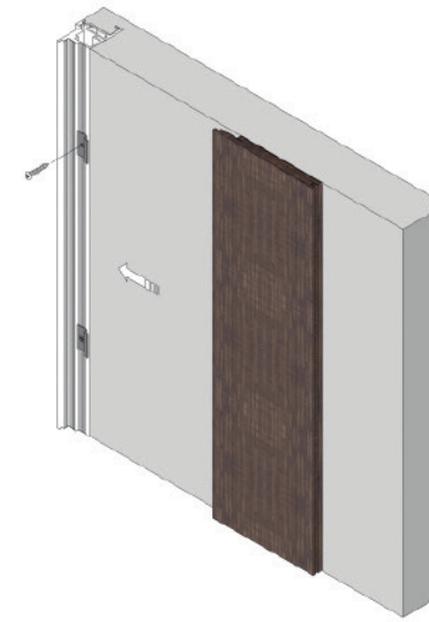
Installazione pannello iniziale Boiserie-V.
